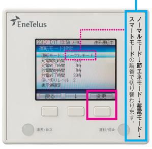
変更を押すとモードが切り替わります。 変更を**3回**押して、スマート モードに切り替えてください。
